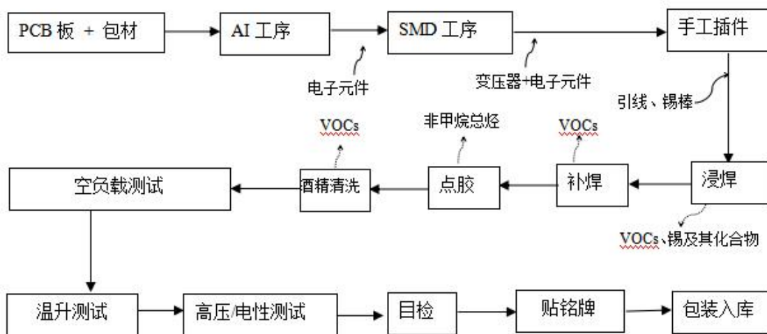
图 2-11 PCBA 开关电源生产工艺流程图
