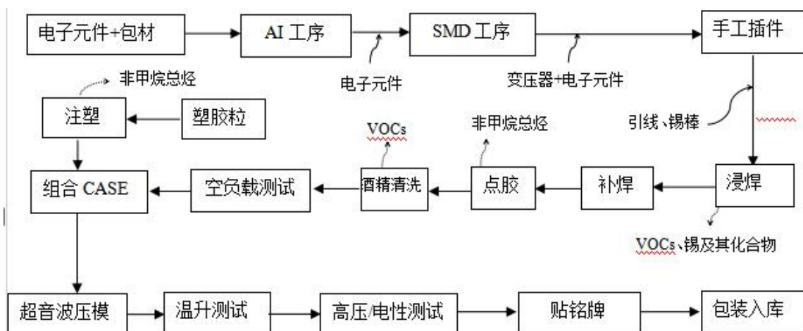
图 2-12 SPS 开关电源生产工艺流程图
